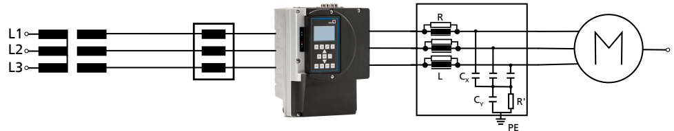
Abb. 19: Netzdrossel und Ausgangsfilter einbauen
